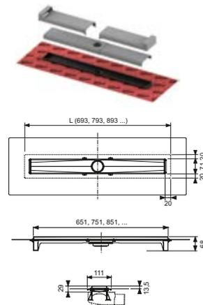
Die Länge des Rinnenkörpers ist abgestimmt auf die Baumaße der 2 DIANA Design-Roste und der verfliesbaren Mulde // Länge L für Rinnen von 693 bis 1193 mm (Sichtmaß nach Einbau L-42 mm) // Jeweils für Raumaufstellung oder für Wandausführung // Montagefüße müssen separat mitbestellt werden.
