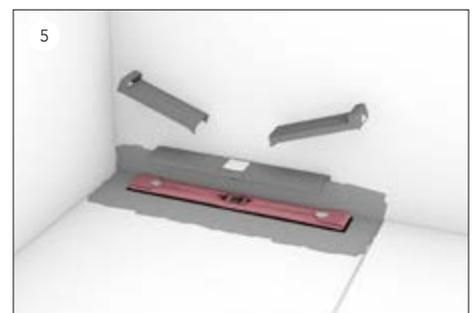
... und Wasser in die Öffnung gegossen. Die Bauzeitenschutzabdeckung muss dazu nicht entfernt oder geöffnet werden.
