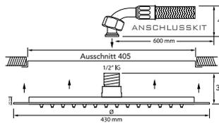
**DIANA L400 Regenpaneel rund, ohne Licht** zum Deckeneinbau, Edelstahl verchromt, Silikonknochen mit Antikalkausstattung, Anschluss 1x 1/2 Zoll, Lieferung inkl. Einbaurahmen und Anschlusskit, Deckenabhangung 100 mm,  $\varnothing$  430 mm, Durchfluss 16 l/Min\*, (DI456204500) 998,- €
