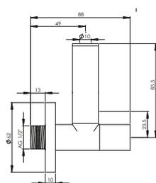
**DIANA-Neu Design-Eckventil PA-gepr., mit Schlauchverblendung 70 mm, 1/2\"/>**
