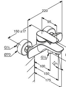
**DIANA S200 Aufputz Wannenfüll- und Brausemischer wandmontage, Durchflussmenge Wanne: 21,4 l/min bei 3 bar und Brause 18,4 l/min bei 3 bar, Luftsprudler M24 x1, Keramik-Kartusche mit Heißwasserbegrenzung, automatische Umstellung Brause/Wanne, verchromt, (DI401440500) 260,- €**
