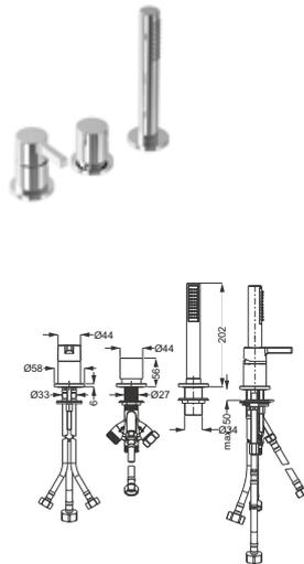
**DIANA L100 3-Loch Wannenfüll- und Brausemischer** für Fliesen- oder Wannenrandmontage, Flexschlauch mit 1/2" IG zum Anschluss einer externen Wannenbefüllung, SoftEmotion-Keramikkartusche, Automatik-Druckumsteller, ausziehbare Stabhandbrause, Nylon-Brauseschlauch, eigensicher gegen Rückfließen,
