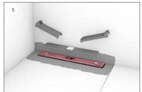
Nach dem Verfüllen mit Estrich wird der Bauzeitschutz entfernt, die erste Schicht der Verbundabdichtung aufgetragen...
