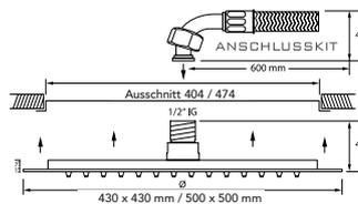
**DIANA L400 Regenpaneel eckig, ohne Licht** zum Deckeneinbau, Edelstahl verchromt, Silikonknochen mit Antikalkausstattung, Anschluss 1x 1/2 Zoll, Lieferung inkl. Einbaurahmen und Anschlusskit, Deckenabhangung 100 mm, 430 x 430 mm, Durchfluss 23 l/Min\*, (DI456214500) 1.055,- €
