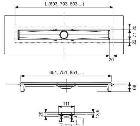
Die Länge des Rinnenkörpers ist abgestimmt auf die Baumaße der 2 DIANA Design-Roste und der verfließbaren Mulde // Länge L für Rinnen von 693 bis 1193 mm (Sichtmaß nach Einbau L-42 mm) // Jeweils für Raumaufstellung oder für Wandausführung // Montagefüße müssen seperat mitbestellt werden.
