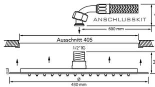
**DIANA L400 Regenpaneel rund, ohne Licht** zum Deckeneinbau, Edelstahl verchromt, Silikonknochen mit Antikalkausstattung, Anschluss 1x 1/2 Zoll, Lieferung inkl. Einbaurahmen und Anschlusskit, Deckenabhangung 100 mm,  $\varnothing$  430 mm, Durchfluss 16 l/Min\*, (DI456204500) 985,- €
