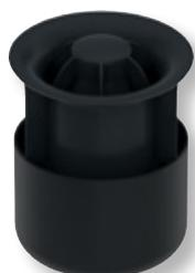
Geruchsverschluss für Abläufe aus Kunststoff (PP) mit innenliegender Dichtlippenmembran als Verdunstungsschutz, Geruchs- und Ungeziefersperre, zweistufiger Geruchsverschluss durch Sperrwasser und Dichtlippenmembran. Nachrüstbar für alle DN 100 Bodenabläufe.
