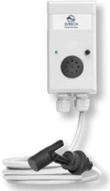
für DITECH Kleinhebeanlagen und Schmutzwasser-Hebeanlagen. Wasserstandsabhängiger Alarmgeber durch Behälterschwimmerschalter. Kunststoffgehäuse IP20, Netzabhängiger Alarm mit eingebautem Signalgeber, Netzunabhängiger Alarmanschluss mit Ladegerät für Akku 9V zum Nachrüsten, Netzstecker 230V/1Ph, potentialfreier Meldekontakt
