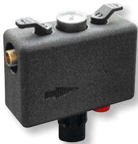
zur automatischen Befüllung von geschlossenen Heizungsanlagen, Gehäuse aus Pressmessing, ein- und ausgangsseitige Absperrungen, Systemtrenner CA nach DIN EN 1717 bis einschließlich Flüssigkeitskategorie 3, Druckminderer und oben liegendem Manometer zur besseren Ablesbarkeit, mit beidseitigen Verschraubungen und Wärmedämmschale
