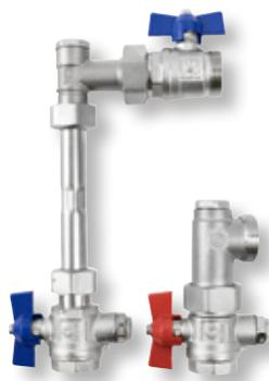
mit Wärmezählervorbereitung, **passend für DITECH Verteileranschlussstationen L und S** mit Vor- und Rücklaufverrohrung aus Edelstahl, Anschlussstück 90° mit zusätzlichem 1/2" Stopfen im Vor- und Rücklauf, Kugelhähne mit Fühleranschluss für direkteintauchende Fühler, (5–5, 2 mm, M10 x 1 IG) im Vorlauf und Rücklauf, Rücklauf mit Kugelhahn vor und hinter dem WMZ-Distanzrohr, Primäranschluss: vertikal, **Hinweis:** Fühlereinbaustück austauschbar durch Fühlereinbaustück, Ø 6 mm M12 x 1 AG
