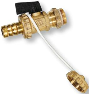
für Sanitär, Solar und Heizungsanlagen universell einsetzbar, Anschluss 1/2" selbstdichtend, voller Durchgang, PN 10, Pressmessing MS 58 mit Schlauchverschraubung, mit KTW-geprüften Dichtungen
