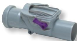
**für fäkalienfreies Abwasser.** Zwei Klappen selbsttätig schließend, eine davon als handverriegelbarer Notverschluss. Zu-/ Ablauf zum Anschluss für HT-Rohr nach DIN 19560 und DIN EN 13564 Typ 2. Einbaukörper: Kunststoff grau. Einbauart: freiliegende Abwasserleitung. Waagrecht.
