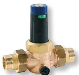
hochwertiger Rotguss-Druckminderer mit beidseitigen Verschraubungen, Schmutzfänger und Manometerstützen. Mit drehbarer Ausgangsdruckanzeige. DVGW zugelassen und schallschutzgeprüft in Klasse 1. Mit Druckmindererkartusche zur problemlosen Wartung ohne Veränderung des Ausgangsdrucks. Betriebsdruck max. 25 bar. Ausgangsdruck 1,5–6 bar, voreingestellt auf 4 bar. PN 25, Einbaumaße ohne Verschraubung wie D06F.
