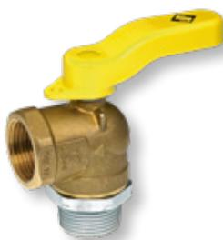
nach DIN EN 331, HTB-Ausführung 650 °C/30 min, mit integriertem Gasströmungswächter Typ K, nach DVGW-VP 305-1, Betriebsdruckbereich: 15 mbar – 100 mbar, eingangs Außengewinde, ausgangs Innengewinde, gesicherter Betätigungsgriff aus Aludruckguss, gelb lackiert, Gehäuse Pressmessing, Vollkugel Messing-verchromt, Kugeldichtung NBR, Schaltwellendichtung aus NBR, Umgebungstemperatur max. 60 °C, HTB 1 bar, DIN-DVGW zertifiziert
