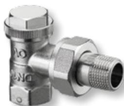
mit proportionaler Voreinstellung für den Einsatz in Warmwasser-Zentralheizungen und Kühlkreisläufen zum Absperrren, Füllen und Entleeren des Heizkörpers, Armatur aus Rotguss/Messing, Gehäuse vernickelt, Ventilkegel aus Messing mit EPDM O-Ringabdichtung, Messing-Schutzkappe mit zusätzlicher Weichdichtung, Einbaumaße nach DIN 3842 mit Anschluss für Gewindeverbindungen, maximale Betriebstemperatur: 120 °C, maximaler Betriebsdruck: 10 bar
