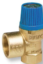
Membran Sicherheitsventil für Warmwasserbereiter nach DIN 4753, aus Messing CW617N, Betriebstemperatur von –10 °C–110 °C, Kennbuchstabe W
