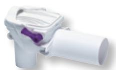
mit zwei selbsttätig schließenden Klappen, eine davon als handverriegelbarer Notverschluss, mit Wandbefestigung. Zulaufanschluss DN 40 senkrecht für bauseitigen Röhrengeruchverschluss, Ablauf DN 50 waagrecht zum Anschluss an HT-Rohr nach DIN 19560. Norm: DIN EN 13564 Typ 5. Einbaukörper: Kunststoff weiß.
