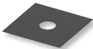
Dichtmanschette für Abläufe, zur Anbindung von Bitumenschweißbahnen, Polymerbitumenschweißbahnen oder EPDM-Dichtbahnen mittels Heißluftschweißverfahren oder vollflächigem Schweißen. Die Fixierung der Dichtmanschette auf dem Universalflansch erfolgt mit dem Pressringset.
