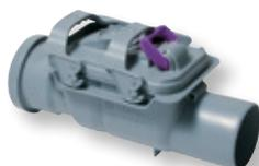
**für fäkalienfreies Abwasser.** Zwei Klappen selbsttätig schließend, eine davon als handverriegelbarer Notverschluss. Zu-/ Ablauf zum Anschluss für HT-Rohr nach DIN 19560. Norm: DIN EN 13564 Typ 2. Einbaukörper: Kunststoff grau. Einbauart: freiliegende Abwasserleitung. Waagrecht.
