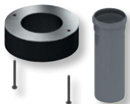
Brandschutzset für die direkte Montage am Ablauf DN 50 senkrecht, zur hochfeuerbeständigen Abschottung von Deckendurchführungen in Massivdecken bis 120 Minuten. Klassifizierung nach DIN EN 13501 für die Brandschutzklasse EI 120, Europäisch Technische Zulassung (ETA-11/0437). Set besteht aus Brandschutzmanschette, 2 Kreuzschlitzschrauben, Kennzeichnungsschild und 150 mm PP-HT Rohr DN 50 nach DIN EN 1451.
