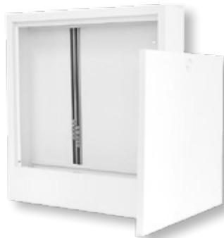
komplett galvanisch verzinkt und beschichtet in weiß RAL 9016, mit höhenverstellbaren Schrankfüßen (130 mm), Stecktür mit Kunststoffdrehriegel, Aufnahme der Verteiler über variable C-Befestigungsschienen.
