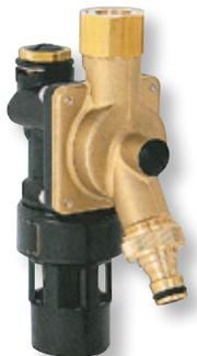
zur Montage an Auslaufventilen, Systemtrenner BA zum Schutz des Trinkwassers vor Nicht-trinkwasser nach DIN EN 1717 bis einschließlich Flüssigkeitskategorie 4\*, Einbau vor Apparate als Entnahmestelle, max. Betriebsdruck: 10 bar, max. Betriebstemperatur: 30°C Eingang / 65°C Ausgang, Medium: Trinkwasser, Durchflussleistung: 1,27 m<sup>3</sup>/h bei Dp 1,5 bar, Gehäuse aus Pressmessing, DN 15, R 1/2", Einbaulage beliebig wenn Ablauftrichter unten
