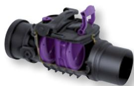
**für fäkalienfreies Abwasser.** Zwei Klappen selbsttätig schließend, eine davon als handverriegelbarer Notverschluss. Norm: DIN EN 13564 Typ 2. Einbaukörper: Kunststoff schwarz.
