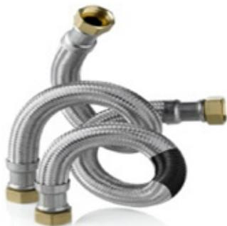
Flexible Panzerschläuche, Material Inliner PERT (Polyethylene of raised temperature), DVGW Trinkwasserzulassung, KTW-BWGL, extrem flexibel und knickfest für engste Einbausituationen geeignet, konstante Flussrate, flexibler korrigierter PERT Innenschlauch, Innen- und Außengewinde aus Messing, rostfreie Edelstahlflechtung AISI 304, Betriebsdruck 10 bar, Temperatur geprüft 90 °C, inklusive Faserdichtung
