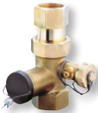
Kappenventil aus Messing zum Absperren und Entleeren sowie zur Kontrolle, Wartung und eventuellem Austausch von Membran-Ausdehnungsgefäßen. Gegen unbeabsichtigtes Schließen mit Draht und Plombe gesichert. wird entsprechend DIN EN 12828 in die Ausdehnungsleitung vor dem Ausdehnungsgefäß eingebaut. Technische Daten: Nenndruck: PN 10. max. Betriebstemperatur: 130 °C.
