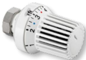
auf individuellen Sollwert begrenzen- und blockierbar, mit Frostschutzsicherung, geprüft und zugelassen gemäß EN 215, Gewindeanschluss M 30x1,5 mm, Sollwertbereich: 7–28 °C, Skalenkappe: 0 \* 1–5
