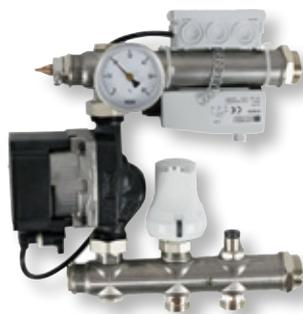
**ausreichend für ca. 120 m<sup>2</sup> Fußbodenheizung**, Temperatur-Festwertregelventil 1/2" mit Tauchfühler 20–50 °C, Übertemperaturschutz durch STB, bei 60 °C, integriertes Regulierventil (Kvs = 2,88 m<sup>3</sup>/h), zur einfachen Einregulierung des Volumenstromes und integriertes Rückschlagventil
