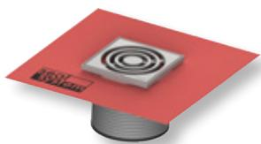
Aufsatzstück mit Rostrahmen aus Kunststoff und werkseitig angebrachter Dichtmanschette, zur Ausführung eines DIN 18534 konformen Anschlusses an die Verbundabdichtung und Designrost 100x100 mm.
