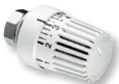
auf individuellen Sollwert innenliegend begrenzen- und blockierbar, mit Memo-Scheibe, mit Frostschutzsicherung und Einstellhilfe für Sehbehinderte, Gewindeanschluss M 30x1,5 mm, Sollwertbereich: 7–28 °C, Skalenkappe 0 \* 1–5
