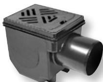
mit herausnehmbarem Rückstaudoppelverschluss und handverriegelbarem Notverschluss, Geruchsverschlusshöhe 60 mm, mit Schlammeimer, Abflussleistung 1,8 l/s. Aufsatzstück aus Kunststoff, höhenverstellbar von 25 mm bis 55 mm, Schlitzrost 150x190 mm mit Easy-Entry-Funktion. Norm: DIN EN 13564 Typ 5. Auslauf: 2,5 Grad (seitlich). Aufsatzstück/Schlitzrost: Kunststoff schwarz. Belastungsklasse: K3 (300 kg).
