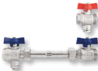
mit Wärmezählervorbereitung, mit Vor- und Rücklaufverrohrung aus Edelstahl, Kugelhähne mit Fühleranschluss für direkteintauchende Fühler, (5–5,2 mm, M10 x 1 IG) im Vorlauf und Rücklauf, Rücklauf mit Kugelhahn vor und hinter dem WMZ-Distanzrohr, Primäranschluss: horizontal, **Hinweis:** Fühlereinbaustück austauschbar durch Fühlereinbaustück, Ø 6 mm M12 x 1 AG, nicht für DITECH Verteileranschlussstationen S und L geeignet
