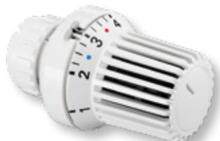
auf individuellen Sollwert begrenzen- und blockierbar, mit Memo-Scheibe, mit Frostschutzsicherung, Anschluss: Klemmverbindung mit Überwurfmutter, passend ohne Adapter auf integrierte Ventilgarnituren und Thermostatventile mit Klemmverbindung der Fa. Danfoss, Baureihe RA, Sollwertbereich 7–28 °C, Skalenkappe 0 \* 1–5
