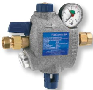
zur automatischen Befüllung von geschlossenen Heizungsanlagen, Gehäuse aus Pressmessing, mit Absperrung, Druckminderer, Manometer, Systemtrenner BA nach DIN EN 1717 bis einschließlich Flüssigkeitskategorie 4, mit beidseitigen Verschraubungen und Wärmedämmschale
