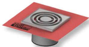
Aufsatzstück mit Rostrahmen aus Kunststoff und werkseitig angebrachter Dichtmanschette, zur Ausführung eines DIN 18534 konformen Anschlusses an die Verbundabdichtung und Designrost 142x142 mm.
