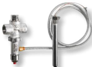
bauteilgeprüft, zur temperaturseitigen Absicherung von Heizkesseln mit eingebauten Warmwasserbereitern in geschlossenen Warmwasserheizungsanlagen entsprechend DIN EN 12828 (DIN 4751), die mit festen Brennstoffen betrieben werden, fest eingestellt auf 97 °C, Tauchhülse 1/2", 142 mm lang, Rohranschluss 3/4" IG
