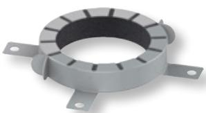
Brandschutzmanschette zur Montage unterhalb der Decke, bei Verwendung der senkrechten Bodenabläufe DN 70 und DN 100 in Verbindung mit einem PP-HT Abwasserrohr nach EN 1451. Zur hochfeuerbeständigen Abschottung der Deckendurchführung in Massivdecken bis 120 Minuten.
