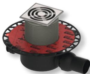
Bodenablaufset waagrecht, Norm, DN 50, Edelstahlrostrahmen mit Edelstahlrost und 2-stufigem Membran-Geruchsverschluss.
