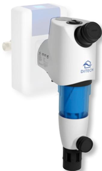
Rückspülfilter mit Druckminderer und Manometer, mit Wartungsanzeige und Wartungsabspernung, Verwendungsbereich: für Trinkwasser bis 30 °C, Betriebsdruck: mindestens 2 bar, maximal 16 bar, nachrüstbar mit Rückspülautomatik. **DITECH Universalflansch DT361325 oder Leckageschutzmodul DT3637 muss separat bestellt werden.**
