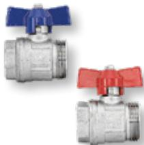
ohne Wärmezählervorbereitung, passend für DITECH Verteileranschlussstationen L und S, mit Vor- und Rücklaufkugelhahn aus Messing vernickelt, Flügelgriff für Vorlauf in rot und Rücklauf in blau, Primäranschluss 3/4" oder 1" Innengewinde horizontal
