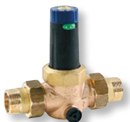
hochwertiger Rotguss-Druckminderer mit beidseitigen Verschraubungen, Schmutzfänger und Manometerstützen. Mit drehbarer Ausgangsdruckanzeige. DVGW zugelassen und schallschutzgeprüft in Klasse 1. Mit Druckmindererkartusche zur problemlosen Wartung ohne Veränderung des Ausgangsdrucks. Betriebsdruck max. 25 bar. Ausgangsdruck 1,5–6 bar, voreingestellt auf 4 bar. PN 25
