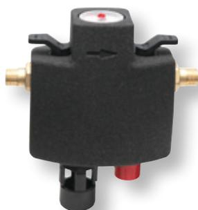
zur automatischen Befüllung von geschlossenen Heizungsanlagen. Mit ein- und ausgangsseitiger Absperrung, Druckminderer, Doppelmanometer, Systemtrenner BA nach DIN EN 1717 einschließlich Flüssigkeitskategorie 4. Ausgangsdruck des Druckminderers regelbar von 1,5 bis 6 bar. Werkseitig auf 1,5 bar voreingestellt. Integrierter Schmutzfänger aus Nirogewebe, Max. Betriebstemperatur 65 °C. Gehäuse aus Pressmessing. Mit beidseitigen Verschraubungen, Wärmedämmschale, DN 20.
