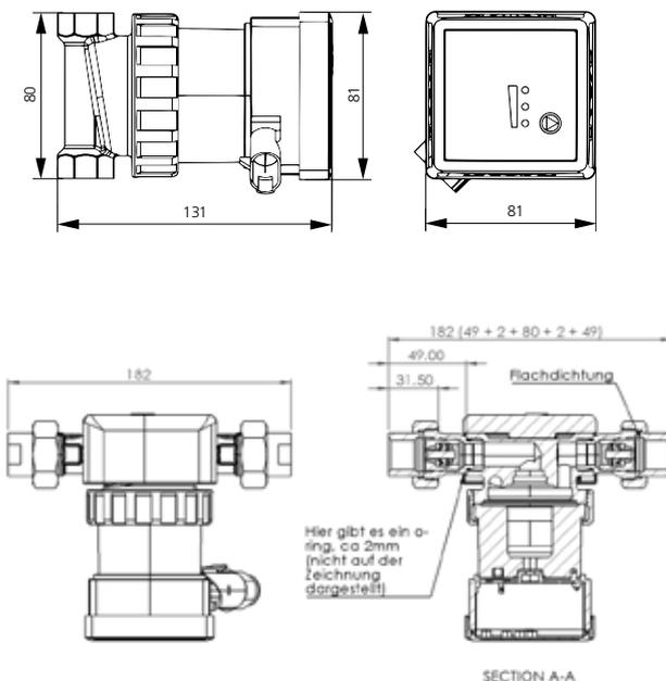
Einbaulänge Pumpe: 80 mm
