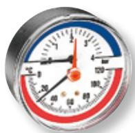
Kunststoffgehäuse, mit automatischem Absperrventil G1/2B, Druckanzeige in bar (blau), Temperaturanzeige 0–120 °C (rot), Sichtscheibe mit verstellbarem roten Markenzeiger, Genauigkeitsklasse: Thermometer 2,0 – Manometer 2,5
