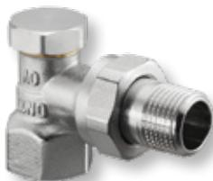
mit proportionaler Voreinstellung für den Einsatz in Warmwasser-Zentralheizungen und Kühlkreisläufen zum Absperrren, Armatur aus Messing, Gehäuse vernickelt, Ventilkegel aus Messing mit EPDM O-Ringabdichtung, Messing Schutzkappe mit zusätzlicher Weichdichtung, Einbaumaße nach DIN 3842 mit Anschluss für Gewindeverbindungen, maximale Betriebstemperatur: 120 °C maximaler Betriebsdruck: 10 bar
