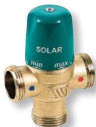
geeignet für Solar und Trinkwasserinstallation PN 10, Einstellbereich 30–65 °C, Werkseinstellung 50 °C als Verbrühungsschutz, Gehäuse aus Messing, maximale Heißwasserzufuhr 85 °C, maximaler Durchfluss 57 l/min bei 3 bar, beliebige Einbaulage, in Übereinstimmung mit EN 1111 und EN 1287, inkl. Verschraubungen
