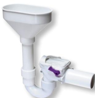
mit zwei selbsttätig schließenden Klappen, eine davon als handverriegelbarer Notverschluss. Mit Wandbefestigung. Röhrengeruchverschluss und Einlauftrichter für Tropfwasseranschluss. Ablauf waagrecht zum Anschluss an HT-Rohr nach DIN 19560. Norm: DIN EN 13564 Typ 5. Ablaufgarnitur: Kunststoff weiß. Einbauart: für Tropfwasser.
