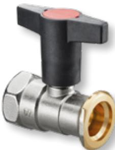
**Innengewinde, Messing vernickelt, Öffnungsdruck maximal 20 mbar, maximaler Betriebsdruck: PN 10, maximale Betriebstemperatur 120 °C**
