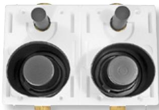
vorgefertigter Unterputz-Montageblock aus FCKW-freiem Styropor inklusive Vormontageeinbausatz für Wasserzähler-KOAX G2-Kapsel, nur eine Verbindungsstelle zwischen Vormontagegehäuse und Spindelventil (Dichtung mit O-Ring), Blindflansch als Spüldeckel, mit Spindelventil, Einputzhaube mit Abtropfschutz, verzinkte Montagewinkel, HBCD-frei, geeignet für Einbau in Leichtbauwänden
