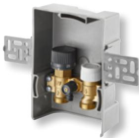
Wandeinbaukasten mit voreinstellbarem Thermostatventil und innenliegendem Rücklauftemperaturbegrenzer, Entlüftungs- und Spülventil, Ventilisolierung, Ventil mit G 3/4" Rohrleitungsanschluss für DITECH Klemmringverschraubungen, Bautiefe: 57 mm, max. Betriebsdruck ps: 10 bar (PN 10), Betriebstemperatur ts: 2 °C bis 100 °C, Sollwertbereich: 20–40 °C (Rücklauftemperatur)
