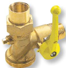
nach DIN EN 331/DIN 3376-2, HTB-Ausführung 650 °C/30 min, Umgebungstemperatur max. 60 °C, eingangs Außengewinde, ausgangs Verschraubung mit Innengewinde, gesicherter Betätigungsgriff, aus Aludruckguss, gelb lackiert, abschließbar, mit Prüfschraube G 1/8" manipulationssicher gemäß TRGI 2018, Gehäuse Pressmessing, Vollkugel Messing-verchromt, Kugeldichtung NBR, Schaltwellendichtung aus NBR, Betriebsdruck MOP5/C1, DIN-DVGW zertifiziert
