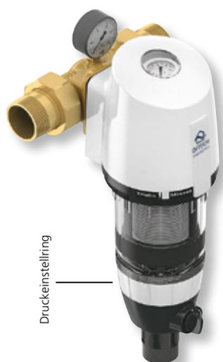
Rückspülfilter mit Druckminderer und Manometer, mit Wartungsanzeige und Wartungsabspernung, Verwendungsbereich: für Trinkwasser bis 30 °C, Betriebsdruck: mindestens 2 bar, maximal 16 bar, nachrüstbar mit Rückspülautomatik. **DITECH Universalflansch max DT3612.. muss separat bestellt werden.**
