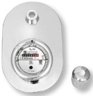
mit patentiertem „Hosenträger“-Dichtungssystem für zuverlässige Bypasskontrolle, mit selbstreinigender Messkammer und unbenetztem Gewinde, Chromgarnitur bestehend aus: einteiliger Rosette mit Zylinder, plombierbar, Ventilgriff chrom, Mediumtemperatur: max. 90 °C, Dauerdurchfluss Q3: 2,50 m<sup>3</sup>/h, metrologische Klasse: R 40 / R 40, Zähleranschlussgewinde: M60x2, Betriebsdruck: 10 bar, Einbau: horizontal / vertikal, Schnittstelle DM1, funkvorbereitet
