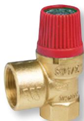
für geschlossene Heizungsanlagen nach DIN EN 12828, Glykolbeständigkeit bis 50 % Glykolanteil, Betriebstemperatur von –10 °C–110 °C, Kennbuchstabe H
